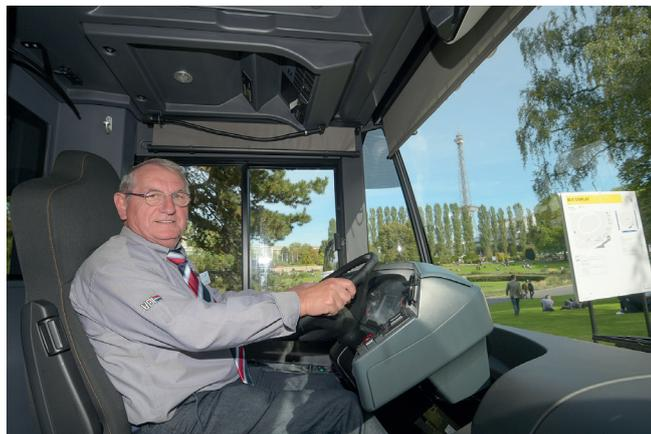
Fahrzeugmodell Linker 12+. Der Bus zeichnet sich durch seine Leichtbauweise und eine hohe Energieeffizienz aus. Eine besonders leistungsstarke Lithium-Titanatoxyd-Batterie und kurze Zwischenladungszeiten sollen Tagesumläufe von bis zu 350 Kilometer möglich machen.
