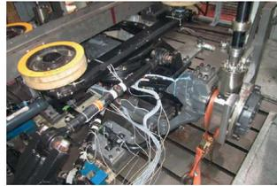
Sensorik für die Betriebsmessung. Foto: Fraunhofer LBF
