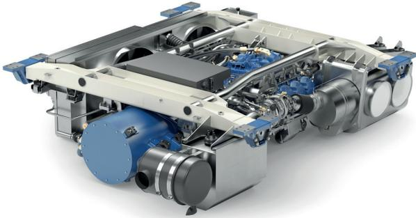
Beim RailPack DE ist ein elektrischer Generator für die Kraftübertragung zuständig.
